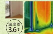
柱や土台のわずかな隙間から冷気が侵入し、温度差が発生しています。
